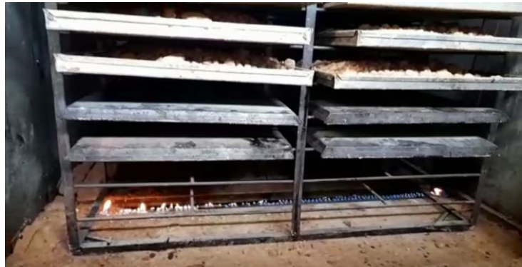
Figura 2. Método actual de secado de panela, vista frontal
