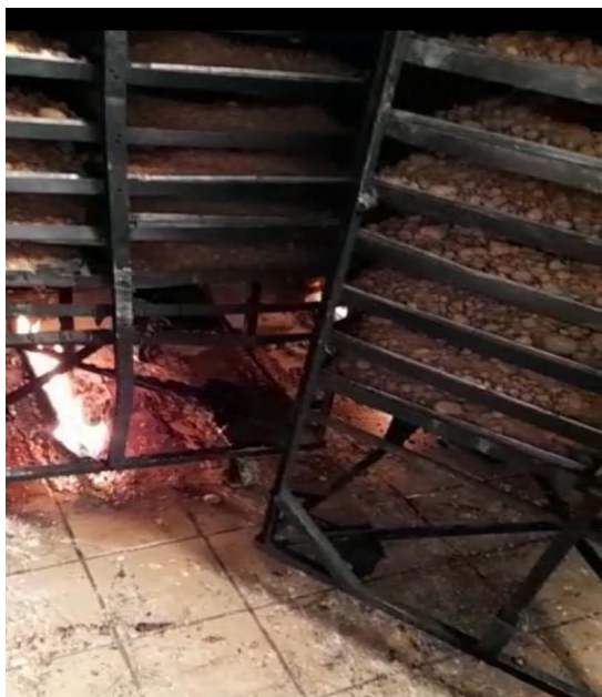
Figura 1. Método actual de secado de panela, vista lateral
