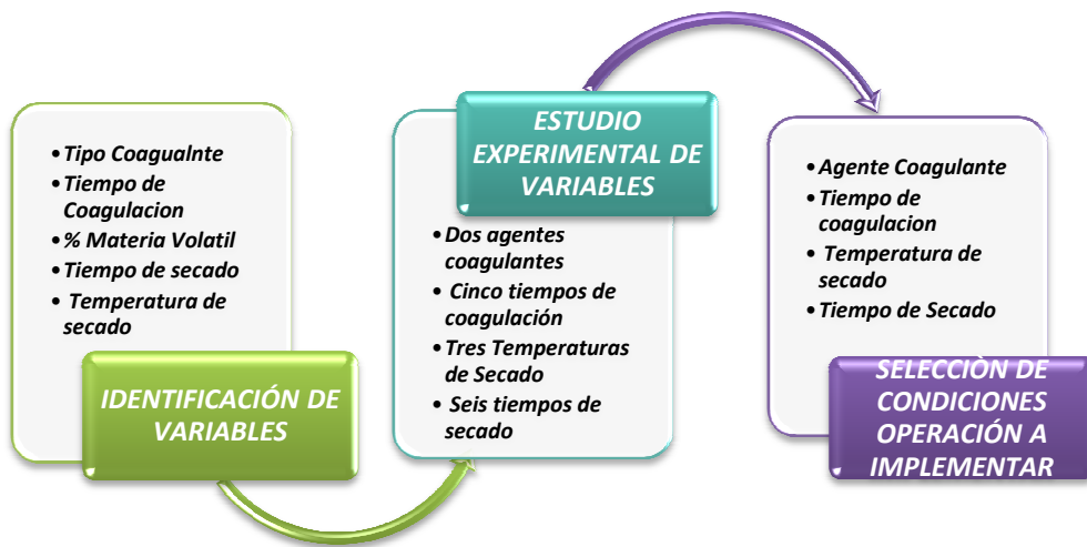
Figura 5. Fases de estudio experimental del proceso de producción de TSR.
