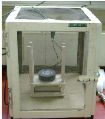
Figura 35. Jaula de Faraday utilizada en las mediciones
