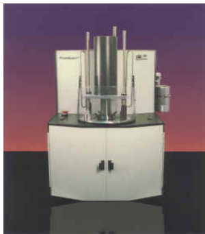
Figura 1. Porosímetro de mercurio
