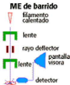
Figura 3. Partes del microscopio electrónico de barrido
