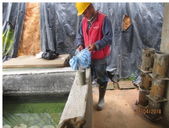
Figura 19. Curado de especímenes utilizando materiales plásticos.
