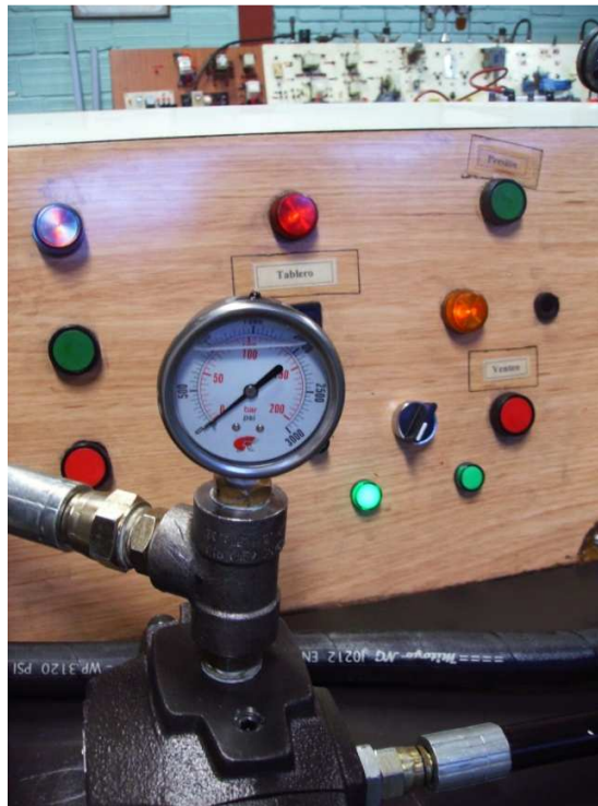
Figura 74. Presión De La Válvula De Descarga En La Etapa De Trabajo
