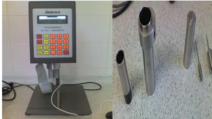
Figura 12. Reómetro rotacional de tipo Brookfield Rheotest II. Laboratorio Ingeniería Química UIS
