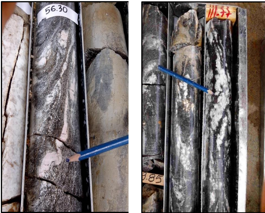
Figura 7a. Gneis con leucosoma granítico plegado. Figura 7b. Gneis con leucosoma granítico.
