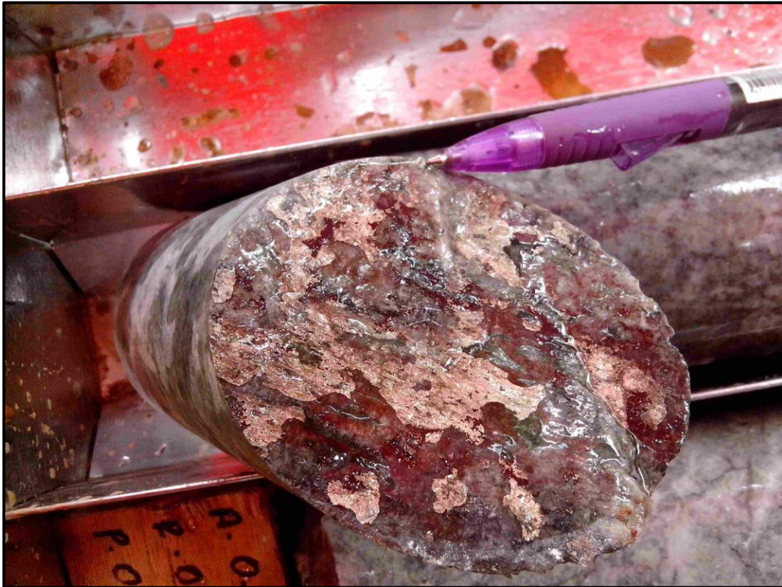
Figura 40. Núcleo con pirita en forma de parches asociado a fallas.
