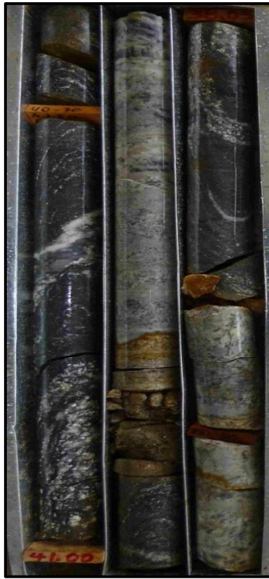
Figura 9b. Contacto entre gneis y Granitoide.
