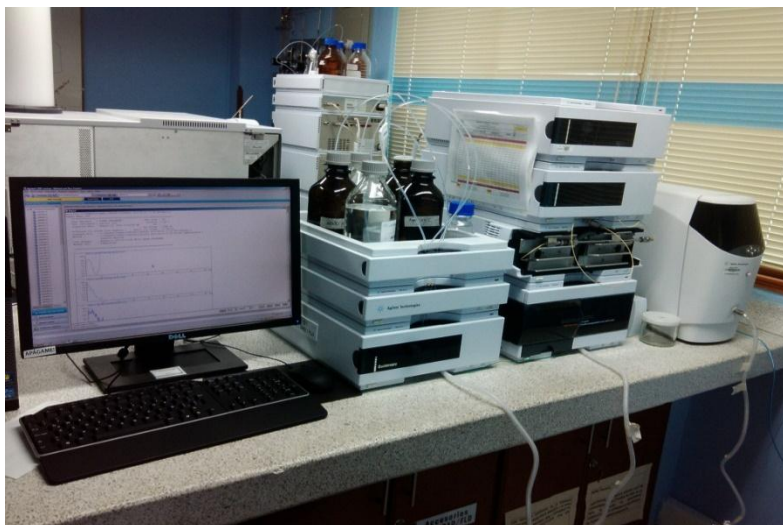
Figura 3. Cromatógrafo líquido de alta eficiencia Agilent Technologies 1200 Series . Imagen tomada por la autora: Laura Patricia Plata, fecha: 02/09/2013. Tomada en el Laboratorio de Cromatografía y Espectrometría de Masas, CROM-MASS.
