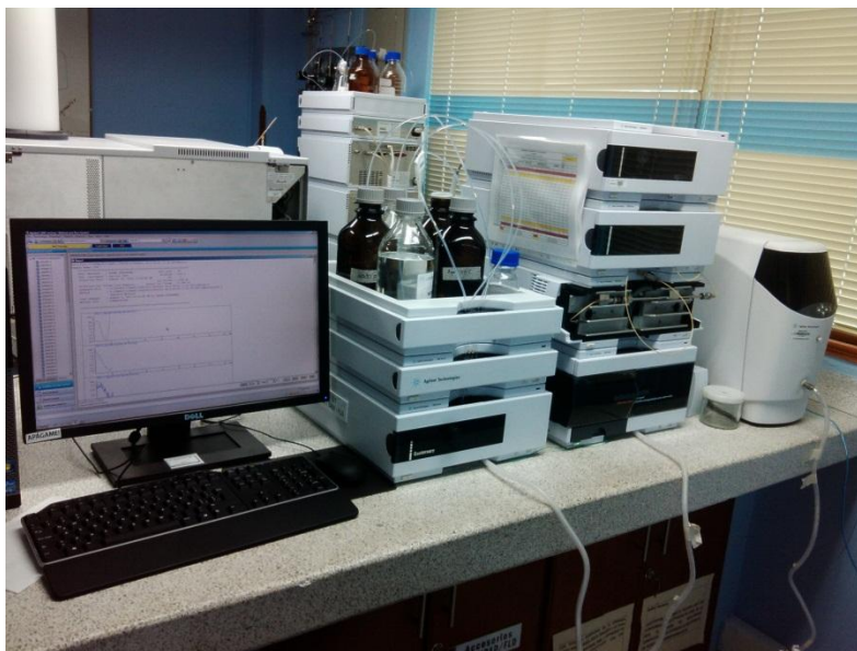
Figura 15. Cromatógrafo líquido de alta eficiencia Agilent Technologies 1200 Series . Imagen tomada por la autora: Laura Patricia Plata Paredes, fecha: 02/09/2013. Tomada en el Laboratorio de Cromatografía y Espectrometría de Masas, CROM-MASS.
