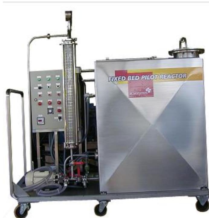
**Figura 5.9.** Reactor piloto de lecho empacado para 10 kg de enzima.
