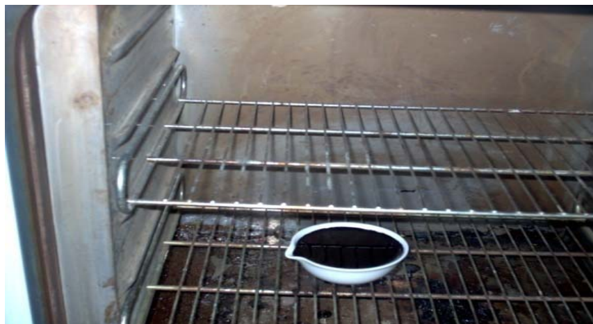
Figura 7. Estufa usada en el proceso para llevar a sequedad el violeta de genciana
