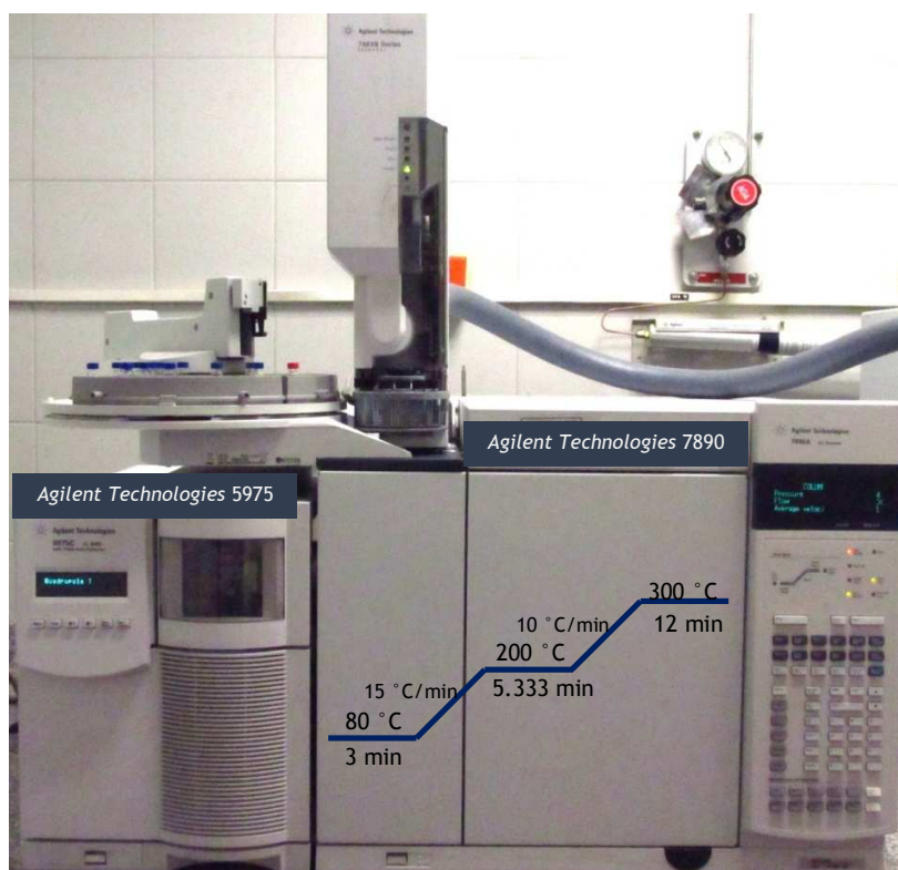
Figura 3. Cromatógrafo de gases Agilent Technologies 7890 Series GC System , acoplado a un detector selectivo de masas Agilent Technologies 5975 , equipado con un puerto de inyección Split/splitless y un inyector automático Agilent 7683 Series .
