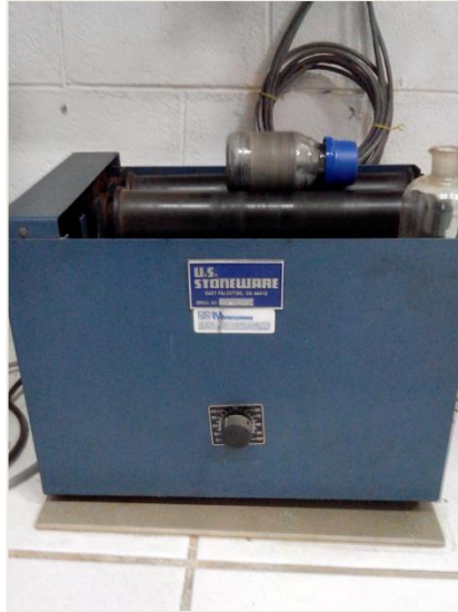
Figura N2. Tratamiento pos-CVD: arreglo de molinos para agitación de MWCNTs.
