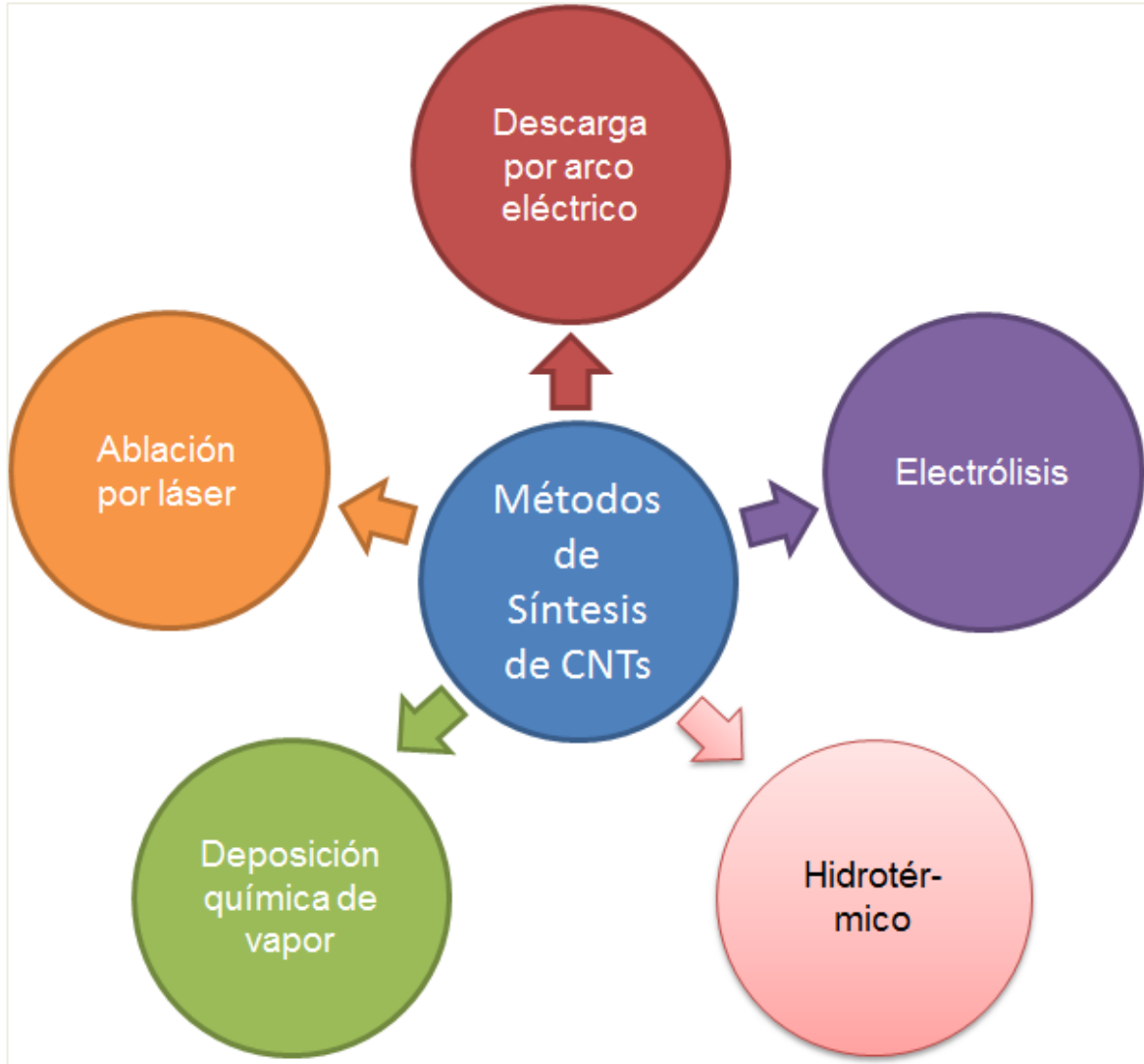
Figura M1. Esquema de los diferentes métodos de síntesis para la producción de CNTs
