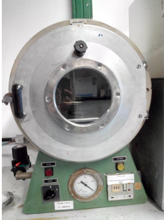
Figura O2. Estufa al vacío Brasimet Heraeus
