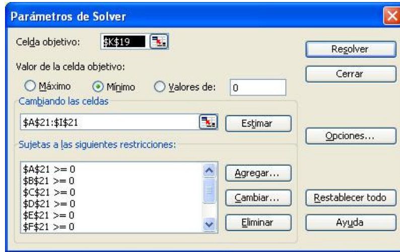
Figura 10. Ventana principal del Solver, en ella se define el procedimiento a realizar y las celdas que se van a modificar.
