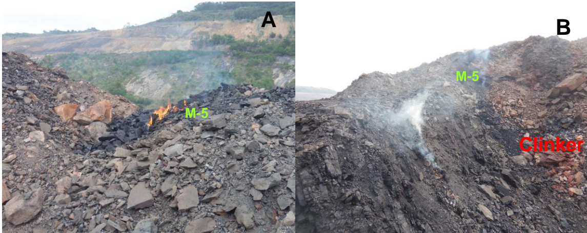
Figura 18. Auto combustión manto 5 bloque oriental. A. llama resultado de la auto combustión. B. humo blanco productos de la combustión de un carbón.
