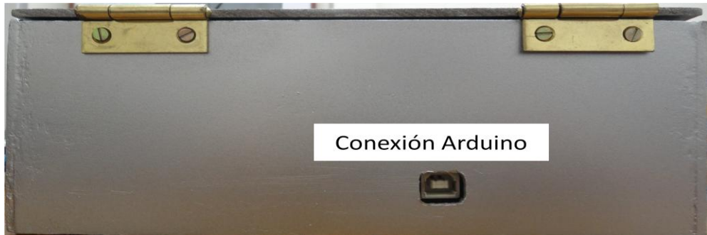
Figura 76. Conexión del arduino
