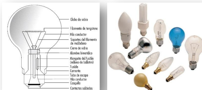
Figura 18. Tipos y partes de una lámpara incandescente.
