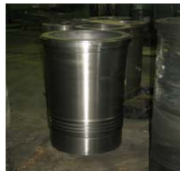
Figura 8. Camisas para grandes motores estacionarios
