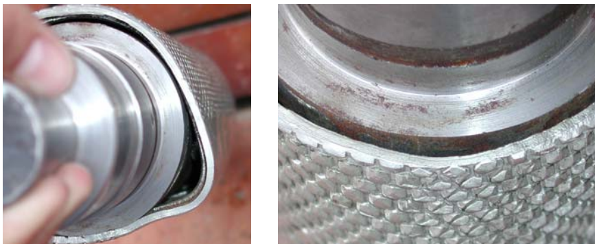
Figura 84. Detalle del abombamiento y despegue de la camisa de estaño
