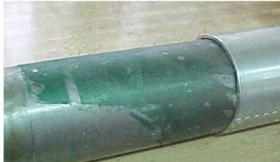
Figura 61. Detalle del adhesivo sobre el eje de acero
