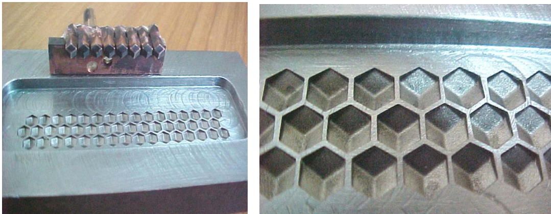
Figura 24. Molde obtenido después de la electroerosión
