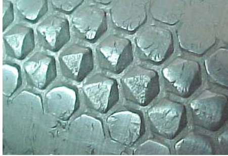
Figura 60. Estampado sobre la camisa de estaño pegada con adhesivo
