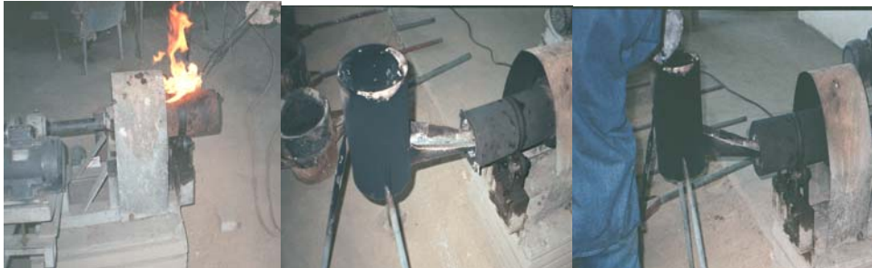
Figura 50. Pasos para obtener el tubo de estaño por centrifugado
