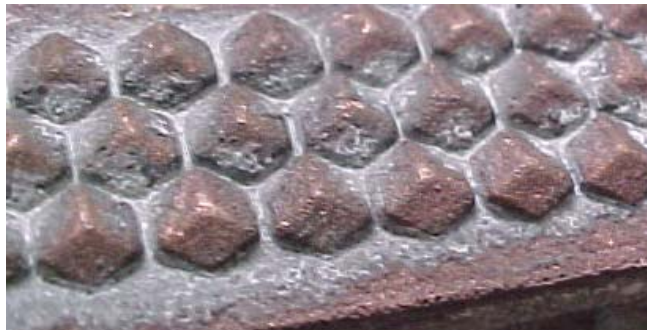
Figura 35. Costra de yeso presente en los electrodos
