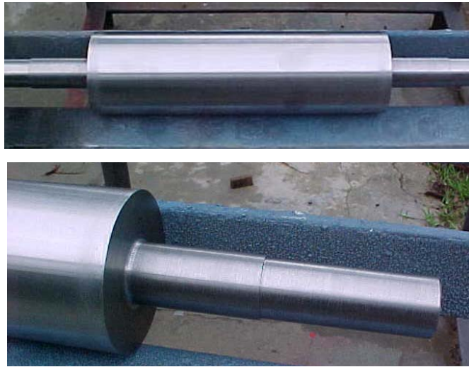
Figura 116. Eje de acero base.
