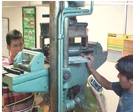
Figura 79. Control de la temperatura usando dos termocuplas
