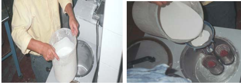
Figura 31. Preparación del yeso y remoción de las burbujas en la máquina de vacío
