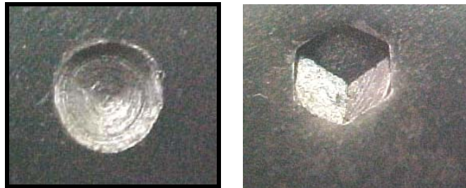
Figura 15. Desbaste preliminar y Punzonado
