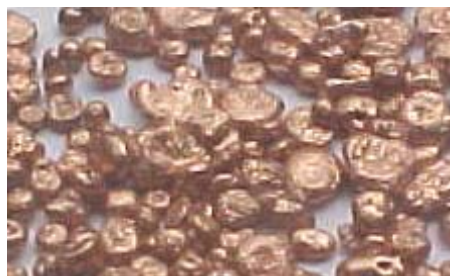
Figura 37. Cobre electrolítico en presentación granulada
