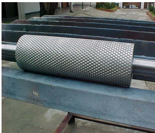
Figura 118. Camisa de estaño adherida al eje de acero
