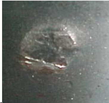
Figura 16. Efecto remache en el lado posterior de la lámina
