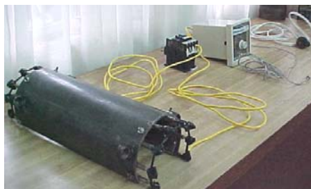
Figura 77. Equipo de calentamiento
