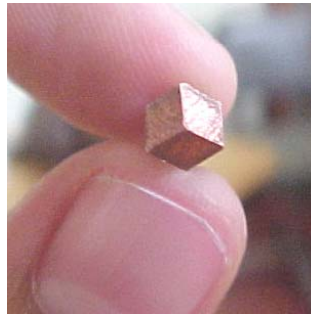
Figura 19. Segmento mecanizado del electrodo de cobre
