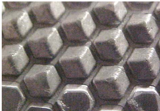
Figura 80. Grabado obtenido durante la prueba de fuerza de estampa
