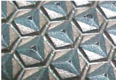
Figura 43. Desgaste en la punta de los alvéolos
