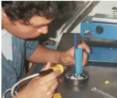
Figura 29. Armado de los árboles
