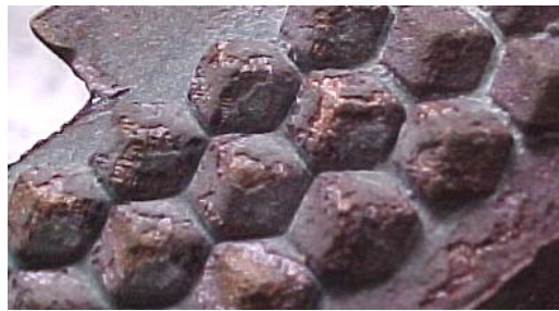
Figura 36. Descascaramiento de la superficie del electrodo
