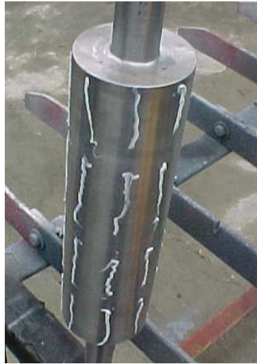
Figura 117. Deposito de adhesivo sobre el eje de acero.
