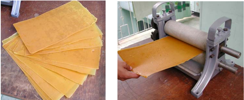
Figura 121. Cera laminada y lista para ser estampada
