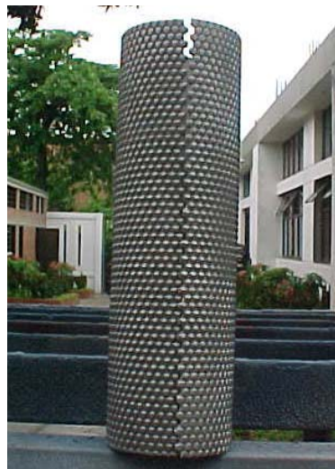
Figura 115. Camisa de estaño arrollada con corte en zigzag
