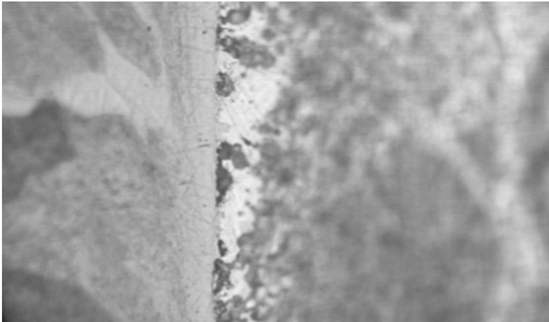
Figura 70. Acercamiento de la interfase estaño-acero a 500X
