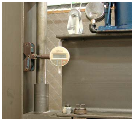
Figura 112. Disposición del deformímetro para la laminación y estampado.
