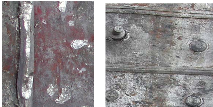
Figura 87. Detalle del cobre adherido a la camisa de estaño
