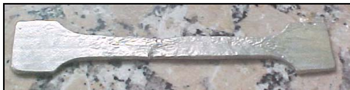
Figura 55. Localización correcta de la falla por tensión.
