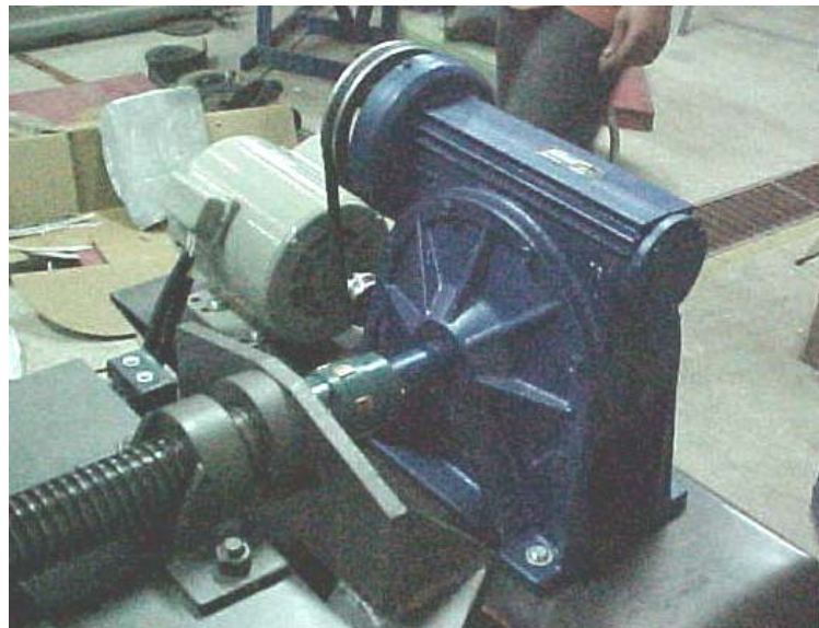
Figura 100. Conjunto del motor, reductor y tornillo de potencia
