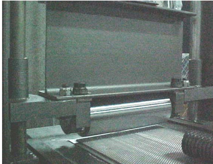
Figura 102. Rodillo laminador sobre la matriz
