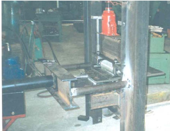
Figura 83. Prototipo usado para determinar la fuerza de empuje
