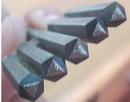
Figura 17. Electrodo de acero desgastado después de la electroerosión
