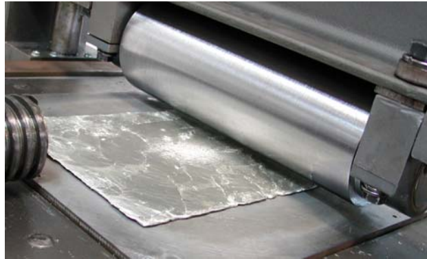
Figura 111. Proceso de laminación del estaño
