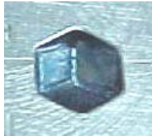
Figura 47. Alvéolo regular obtenido por medio de una máquina CNC
