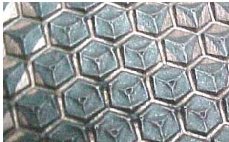
Figura 45. Aplastamiento de una zona de la plancha en el electroerosionado
