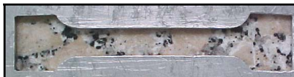
Figura 53. Molde de aluminio para obtener las probetas de estaño
