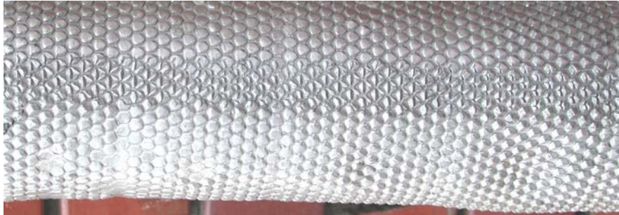
Figura 86. Detalle de la poca profundidad alcanzada por los alvéolos localizados sobre las ranuras y agujeros
