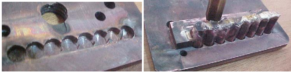
Figura 23. Base de cobre para alineamiento de la altura de los segmentos
