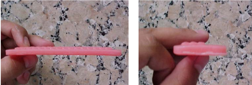
Figura 39. Torceduras presentes en el electrodo de cera
