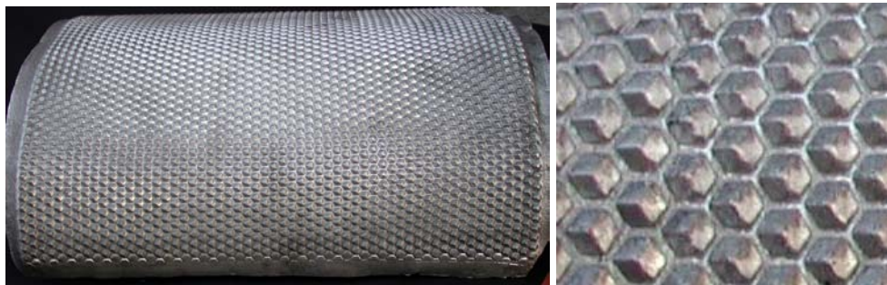
Figura 90. Lámina estampada con un grabado aceptable y su detalle
