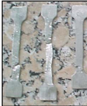
Figura 54. Probetas fallidas durante la prueba
