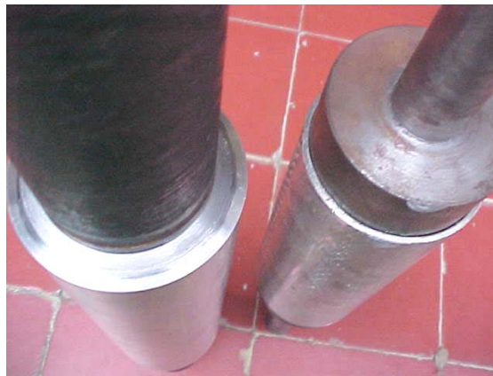
Figura 73. Comparación entre los dos tipos de camisa obtenidos
