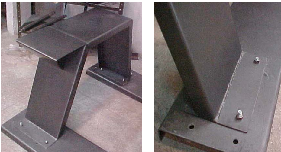
Figura 94. Mesa del motor-reductor y detalle del anclaje
