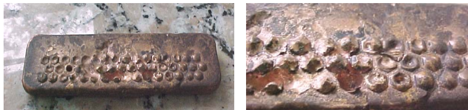
Figura 27. Problemas de herviduras, poros y oxidación en el electrodo
