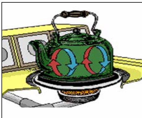
Figura 8. Transferencia de calor por convección
