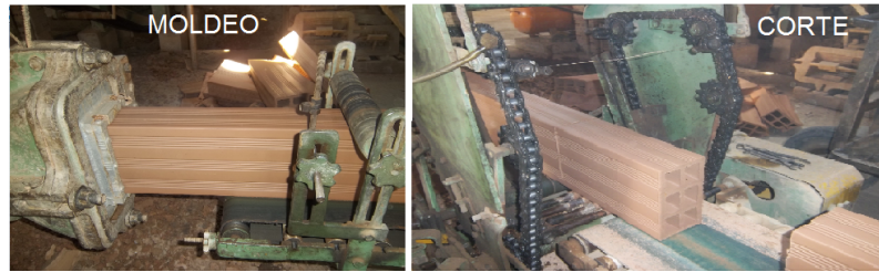
Figura 4: Moldeo y corte empresa LADRILLOS Y ACABADOS S.A.S
