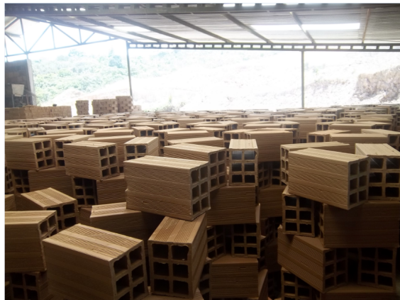
Figura 5: Secado natural LADRILLOS Y ACABADOS S.A.S
