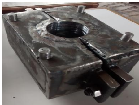
Figura 7. Molde Metálico Para Producción de los Aisladores.
