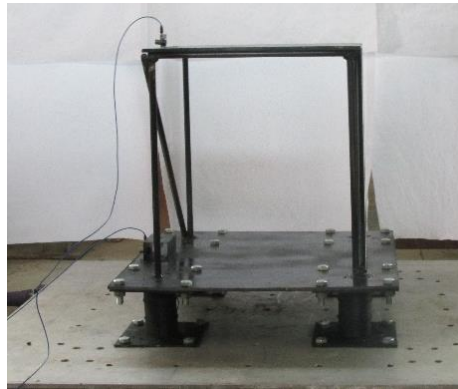
Figura 15. Acelerómetros piezoeléctricos instalados en la estructura.
