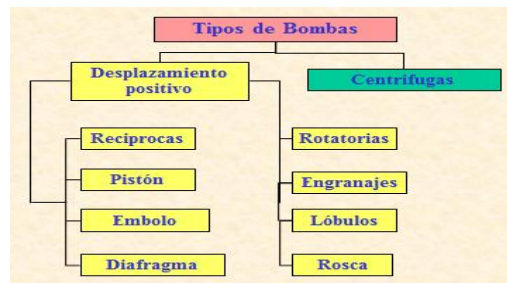
Figura 8. Diagrama tipos de Bombas
