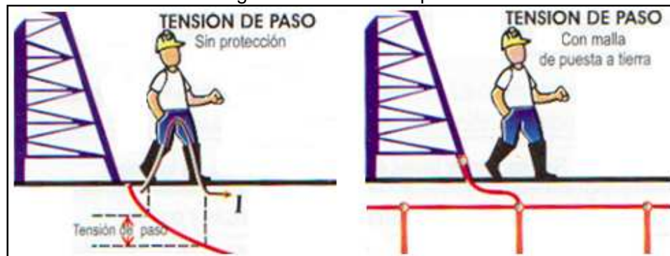
Figura 53. Tensión de paso
