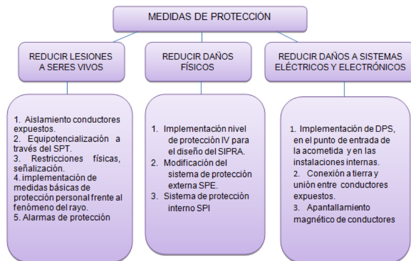
Figura 68. Medidas de protección a implementar para la reducción de riesgos, edificio Álvaro Beltrán Pinzón
