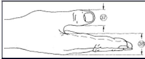
Figura 2.: Tabla con las principales medidas de la mano (Según Norma DIN 33.402 segunda parte.
