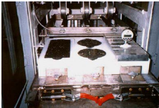
Figura 12. Analizador de Pavimentos Asfálticos (A.P.A.)
