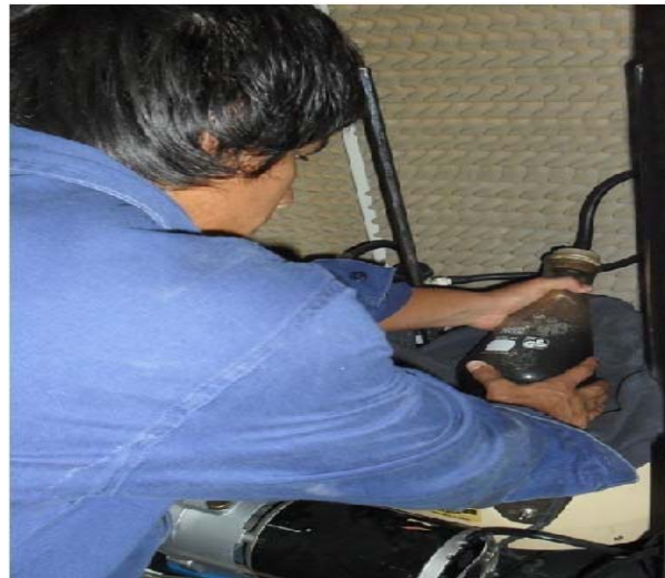
Figura 22. Ensayo de gravedad específica máxima teórica (Gmm).
