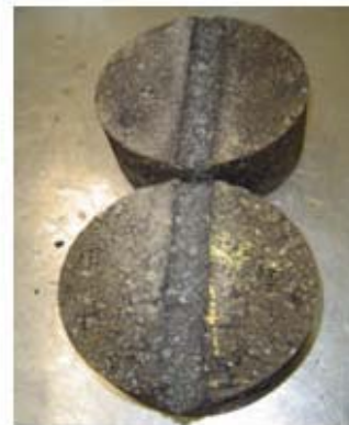
Figura 13. Evaluación de la deformación permanente en el A.P.A.
