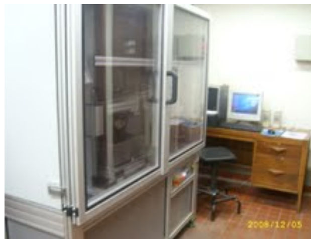
Figura 10. Cámara de temperatura controlada
