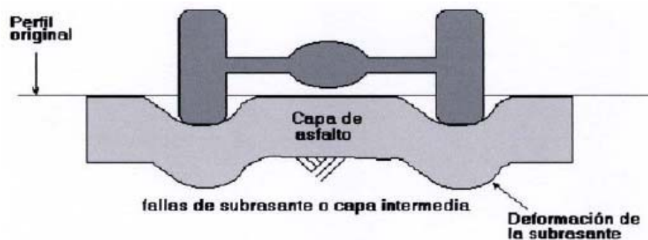
Figura 5. Roderas por fallas en la subrasante
