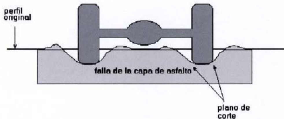
Figura 6. Roderas por fallas en las capas asfálticas
