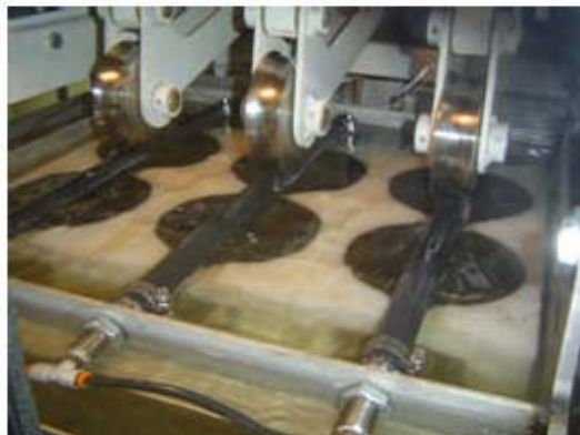
Figura 13. Evaluación de la deformación permanente en el A.P.A.
