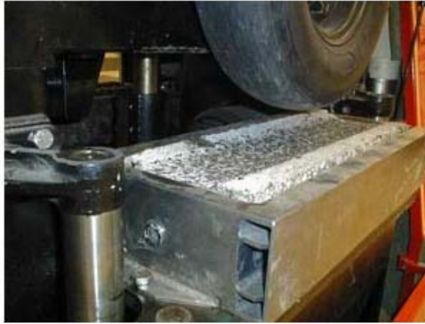
Figura 15. Acercamiento de la llanta y la placa en el ensayo de rodera francés
