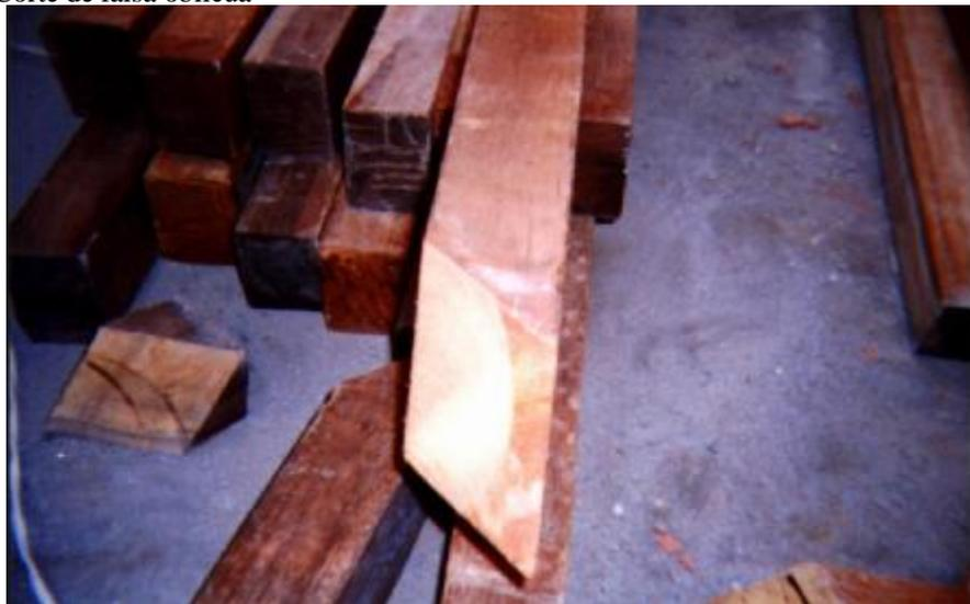
Las falsas se pueden clasificar como falsas con uniones oblicuas o falsas con uniones inclinadas, estos dos tipos de cortes se deben medir y dibujar sobre la madera antes de ser cortados por la sierra.
