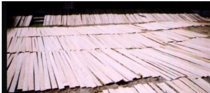
Figura 36. Secado con aireación.
