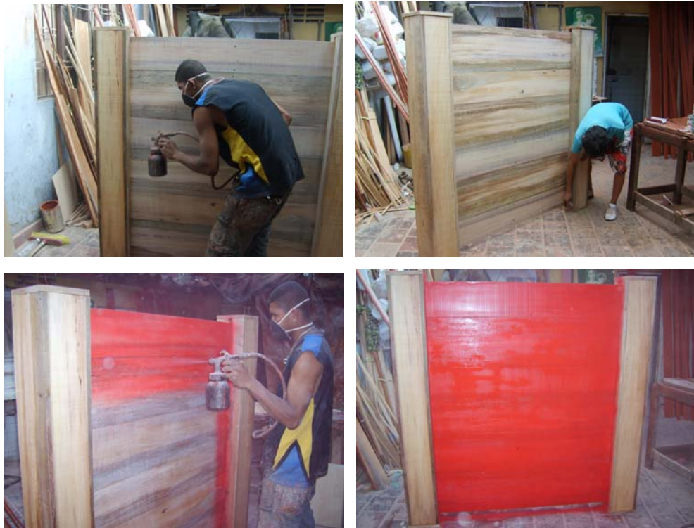
Figura 32. Lijado y pintura
