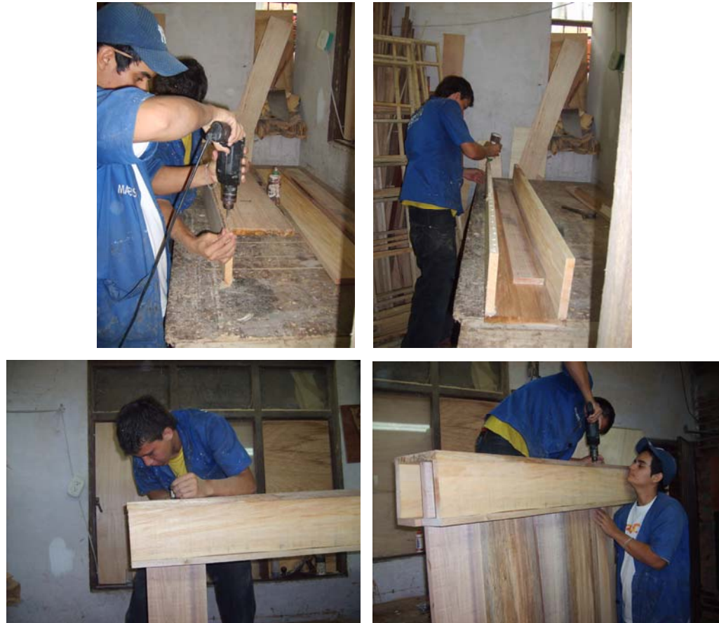
Figura 31. Proceso de Construcción de los Burladeros
