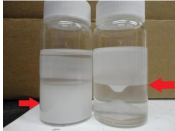
Fig. 4.2. Sistema bifásico: (Izq.) zeolita comercial ubicada en la fase acuosa, (Der.) zeolita tratada suspendida en la interface líquido-líquido.
