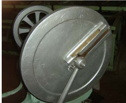
Figura 106. Tornillo de graduación de avance de la picadora
