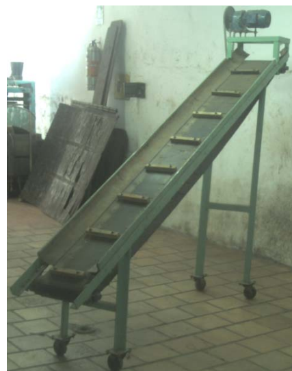
Figura 36. Aspecto final de la banda transportadora móvil.
