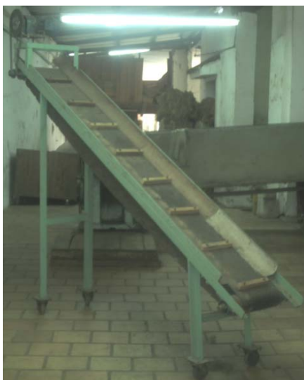
Figura 36. Aspecto final de la banda transportadora móvil.
