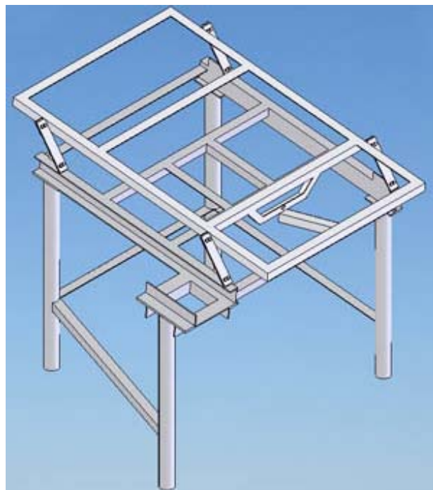
Figura 62. Estructura de la Zaranda.
