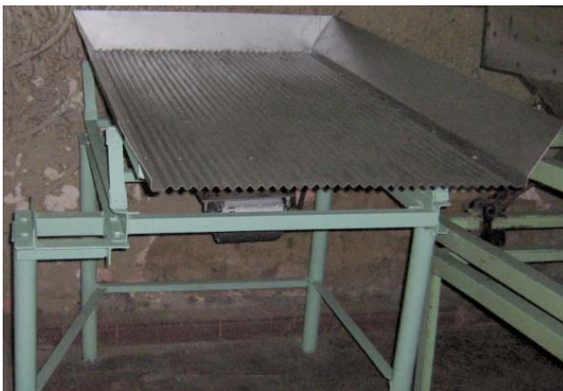
Figura 79. Aspecto final de la zaranda direccionadora.
