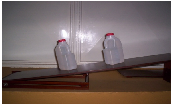
Figura 8. Determinación de la estabilidad.
