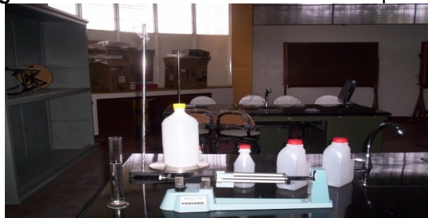
Figura 7. Prueba de determinación de la capacidad.
