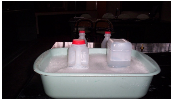
Figura 9. Determinación de la resistencia al ataque químico.
