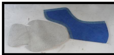
Imagen 8. Pieza sin desbastar (izquierda) y desbastada (derecha).
