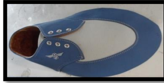
Imagen 10. Corte totalmente guarnecido
