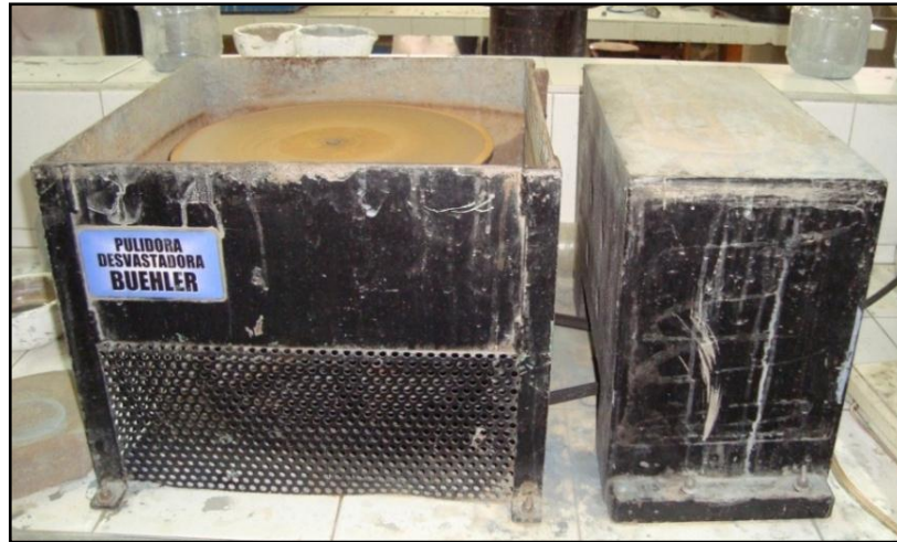
Figura 3. Pulidora desvastadora marca BUEHLER. Laboratorio de preparación de muestras Escuela de Geología UIS.
