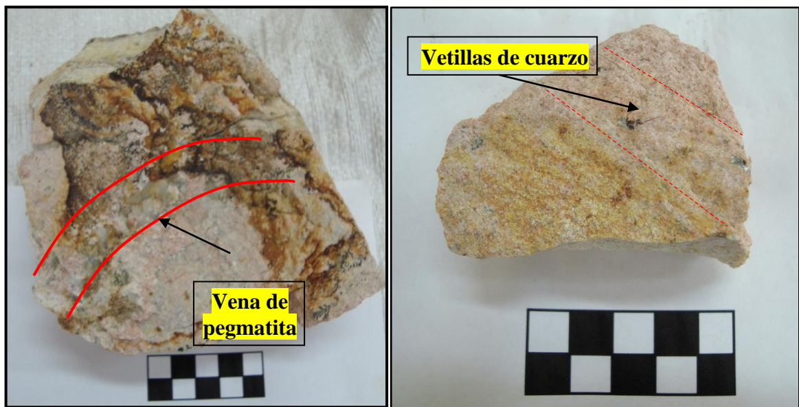
Figura 17. A) Fotografía tomada a muestra de mano estación TEG-E2-001, la cual se observa la vena de textura pegmatita. B) Muestra TEG-E2-002, en la cual se observan pequeñas vetillas de aproximadamente 1mm a 2mm de tamaño.
