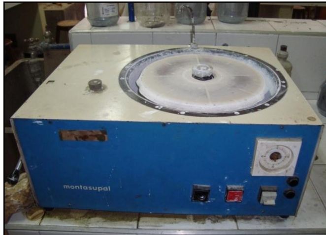
Figura 5. Pulidora con paño, marca Montasupal. Laboratorio de preparación de muestras Escuela de Geología UIS.
