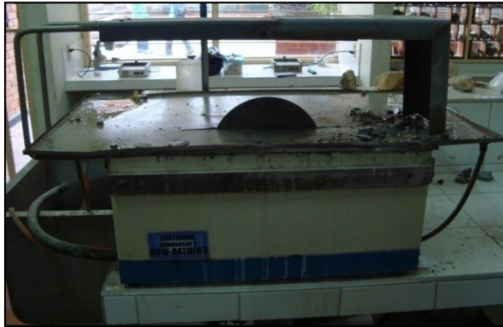
Figura 1. Cortadora Minosecar 2 ROW-RATHENO. Laboratorio de preparación de muestras Escuela de Geología UIS.
