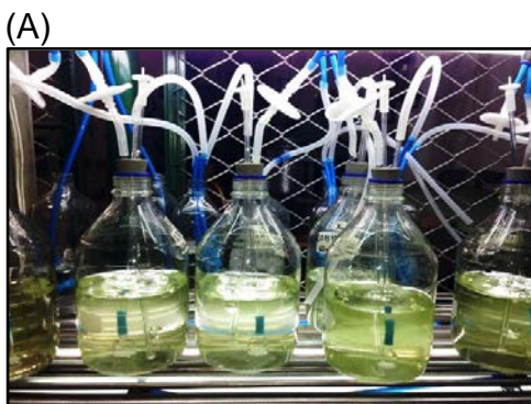
Figura 7. Montaje experimental para los cultivos de B. braunii .
