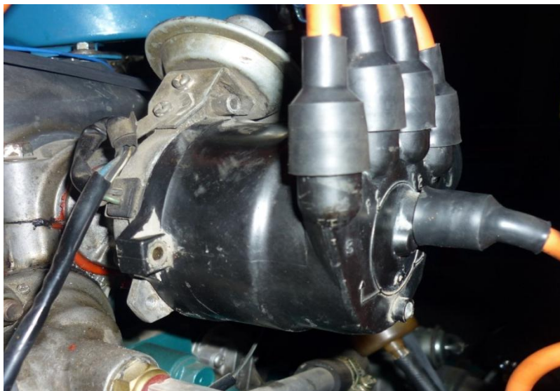
Figura 56. Inducción de la falla mediante giro de la bobina de encendido.
