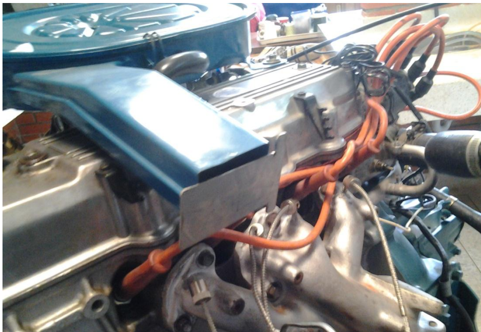
Figura 43. Inducción de la falla mediante obstrucción en la succión.
