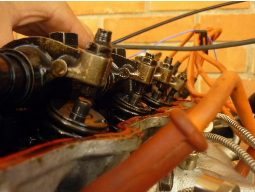
Figura 74. Inducción de falla descalibración de una válvula de escape.
