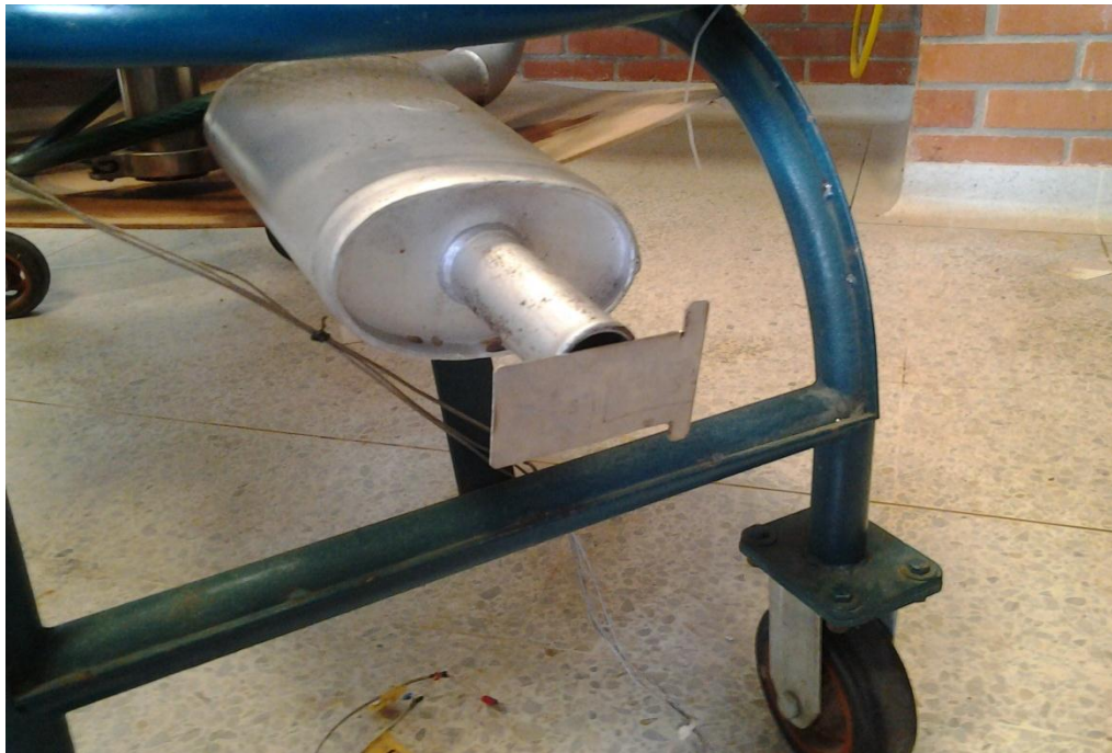
Figura 49. Inducción de la falla mediante obstrucción de la descarga.
