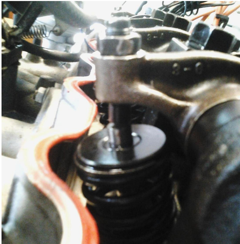
Figura 65. Inducción de la falla descalibración de válvula 2 de admisión.
