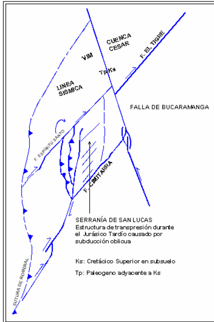
Figura 3. Esquema estructural (deformación transpresiva) de la Serranía de San Lucas y su relación con la Falla Palestina. En Navas y Páez (2006). Modificado de Barrero (2001).
