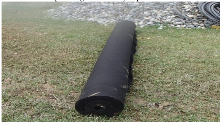
Ilustración 37: Inspección geotextil no tejido para filtro.
