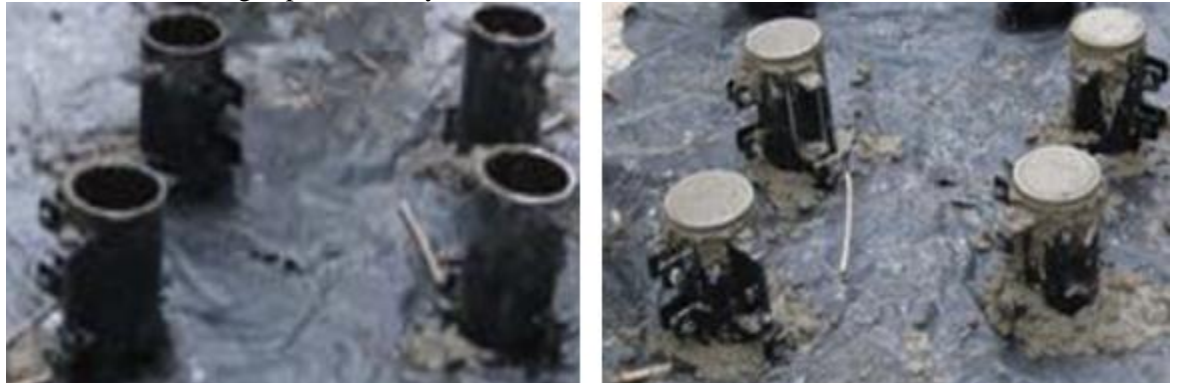
Ilustración 34: Testigos para el ensayo de resistencia del concreto.
