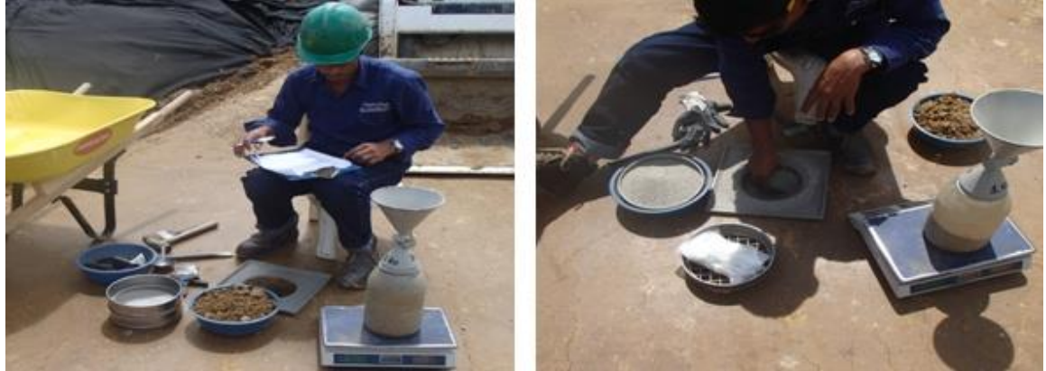
Ilustración 35: Ensayo de densidad del suelo de las capas del relleno.
