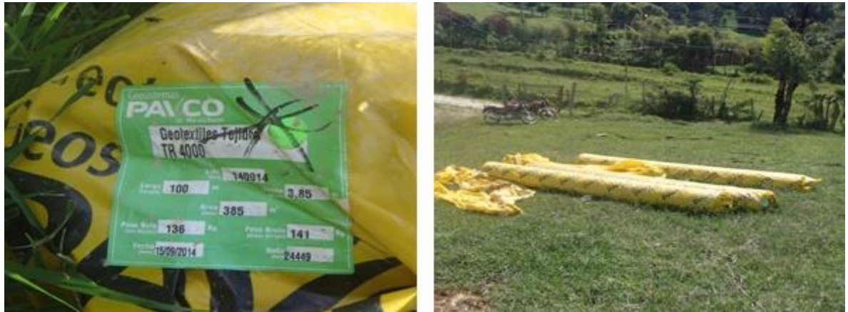
.Ilustración 36: Inspección del Geosintetico.
