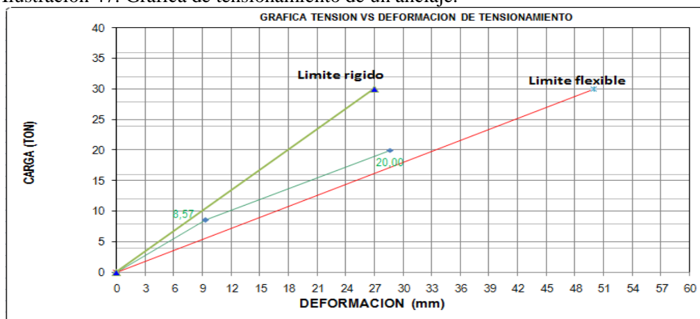
Ilustración 47: Grafica de tensionamiento de un anclaje.
