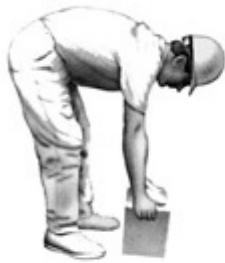
Manera incorrecta de levantar
