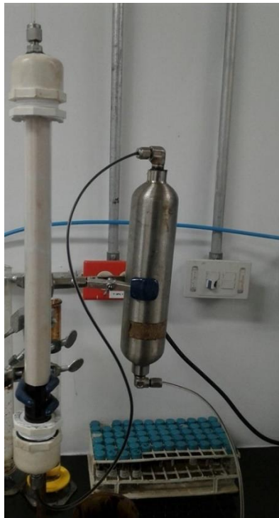
Figura 17. Montaje para el inicio de la saturación de aceite
