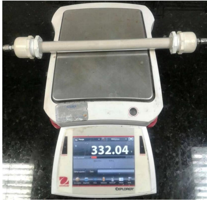
Figura 16. Empaque de arena finalizado y pesado para dar inicio a la inyección
