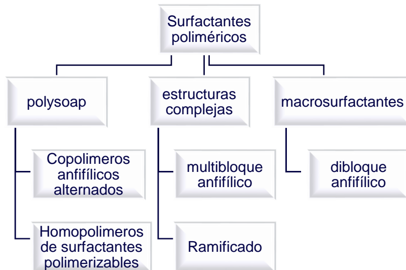
Figura 5. clasificación de los surfactantes poliméricos según su estructura molecular.
