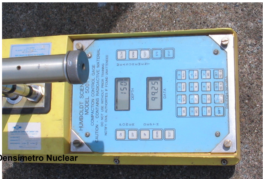
Foto 30. Medida de compactación Base Granular
