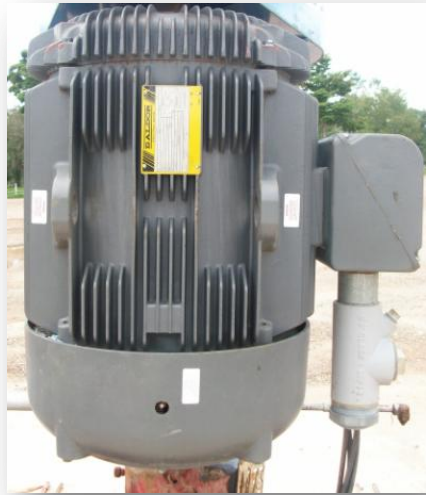
Figura 4. Motor eléctrico adecuado para sistemas PCP.
