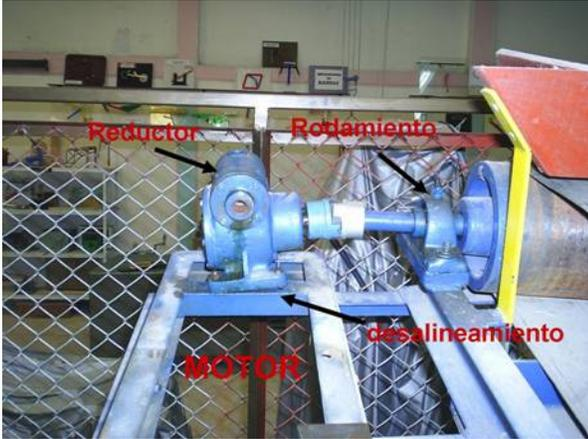
Figura 4. Rodamiento que soporta el eje del tambor de accionamiento
