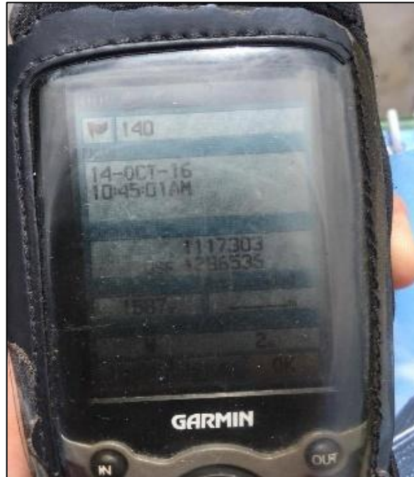
Figura 5. Toma de Coordenadas Planas con el GPS suministrado por la CDMB
