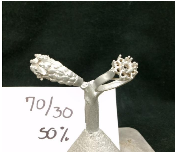
Figura 31: Fundición de aleación Al-Zn con revestimiento refractario de 70/30 y 50 ml de agua por 100 g de polvo
