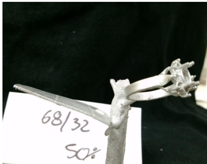
Figura 31: Fundición de aleación Al-Zn con revestimiento refractario de 70/30 y 50 ml de agua por 100 g de polvo
