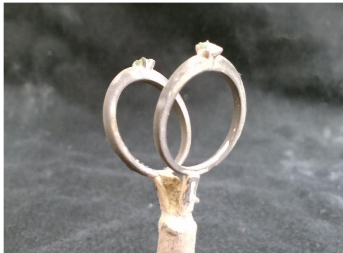
Figura 35: Anillos obtenidos por microfundición a la cera perdida con esmeraldas pre engastadas en aleación de Ag- Cu.
