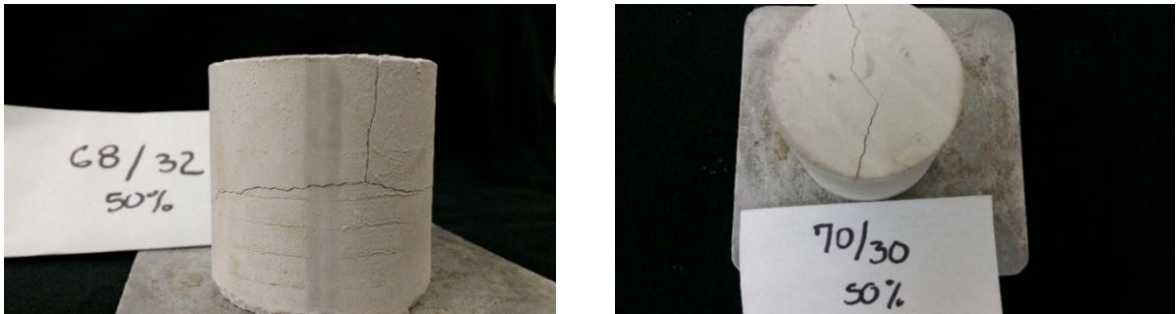
Figura 24: Probetas de arena sílice calcinada luego de ser sometidas a tratamiento térmico
