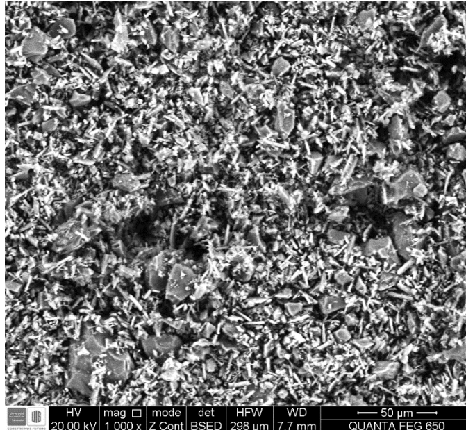
Figura 29: Micrografía SEM, electrones retro dispersados mezcla 72/28 1000x.
