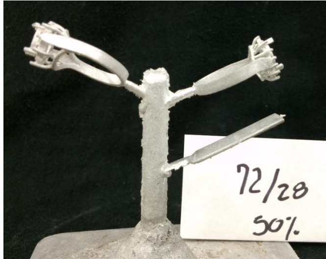
Figura 32: Fundición de aleación Al-Zn con revestimiento refractario 72/28 y 50 ml de agua por 100 g de polvo.
