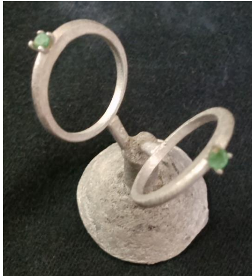
Figura 35: Anillos obtenidos por microfundición a la cera perdida con esmeraldas pre engastadas en aleación de Ag- Cu.
