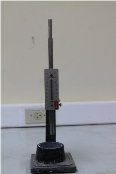
Anexo A. 3: Aguja de Vicat de 1mm de diámetro y 300 gr de peso.
