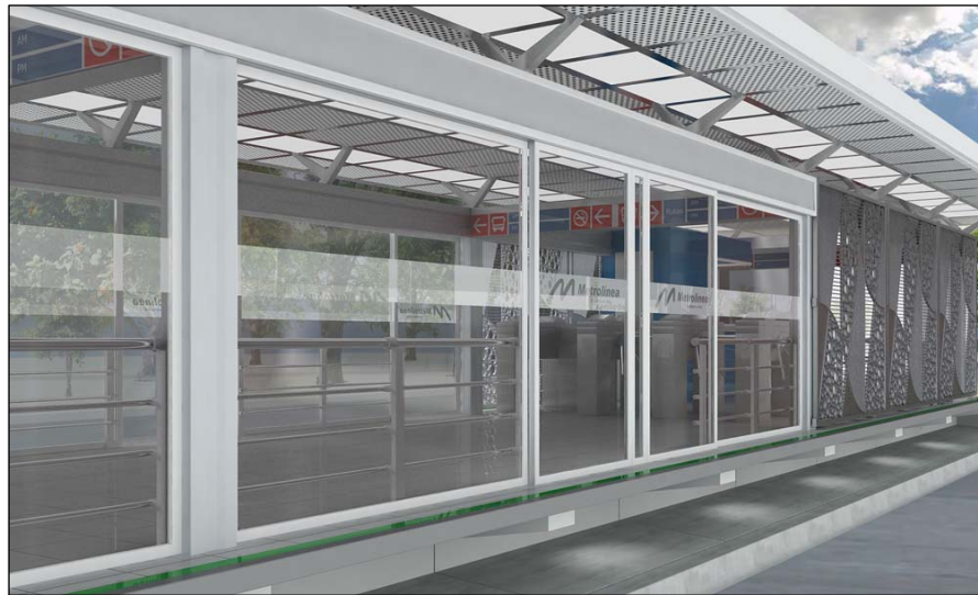
Figura 8. Detalle de puerta corrediza telescópica elaborado en 3d.
