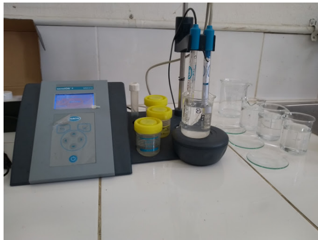
Figura 17. Proceso de calibración: medición con el sensor sensION™+ MM374
