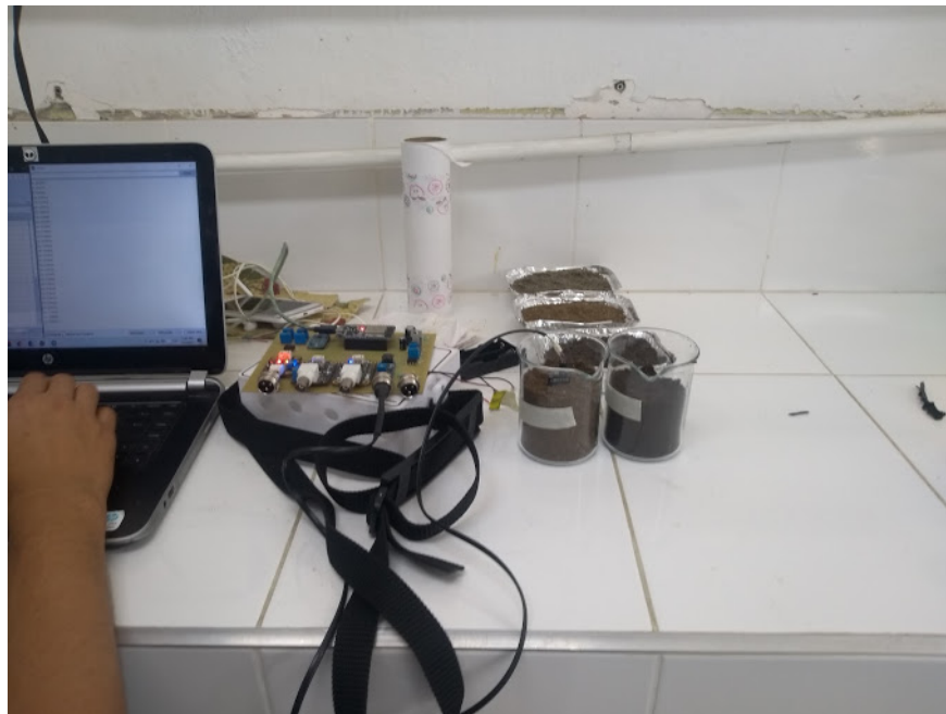
Figura 31. Proceso de calibración: Medición con sensor de humedad YL-69
