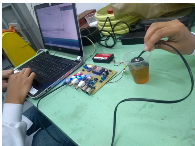
Figura 23. Proceso de calibración: medición con sensor SEN0189
