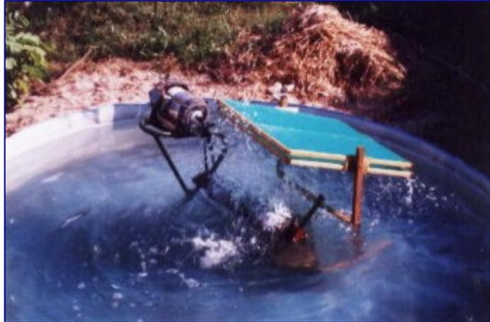
Utilización de un panel para retardar la caída de agua
