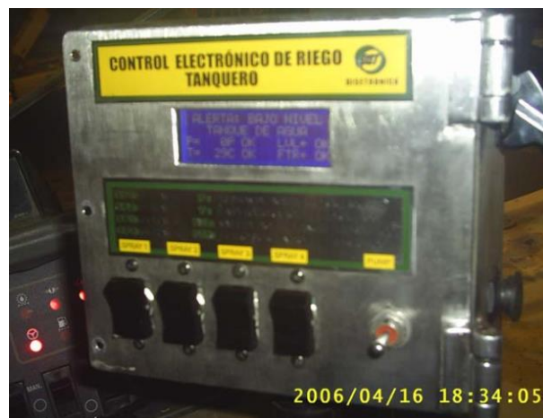
Figura 17. Panel del módulo electrónico de control de riego.
