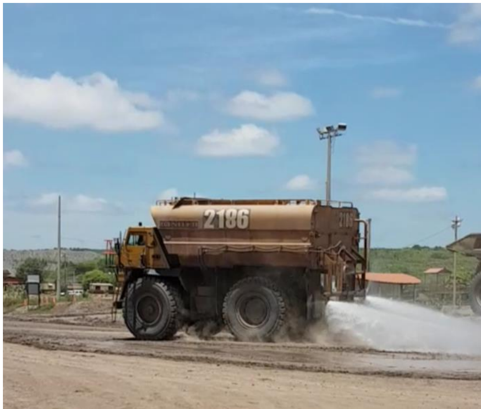
Figura 7. Camión tanquero Caterpillar modelo 777C
