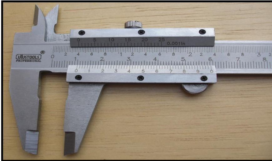
Figura 13. Calibrador y sus divisiones
