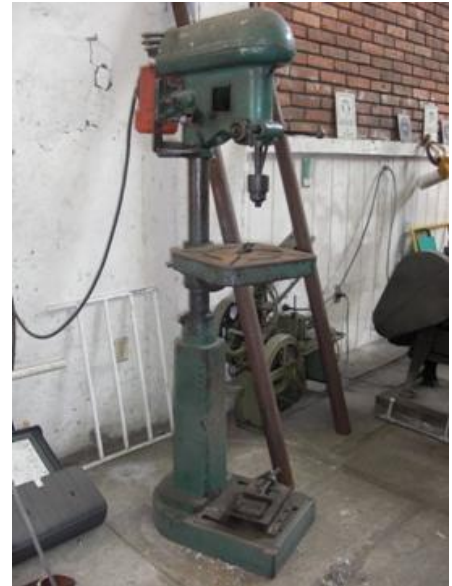
Figura 2. Taladro de árbol; Fuente: Autores
