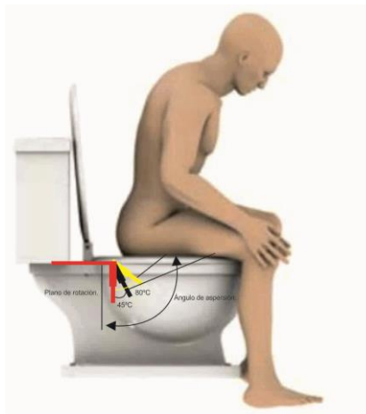
Figura 55. Esquema de aspersión de agua / lavado.
