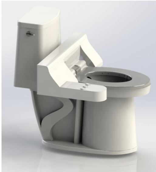
Figura 116. Diseño anticipatorio del modelo funcional sobre inodoro.
