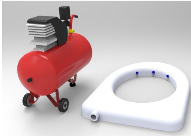
Figura 38. Alternativa sub-sistema de secado por aire comprimido.
