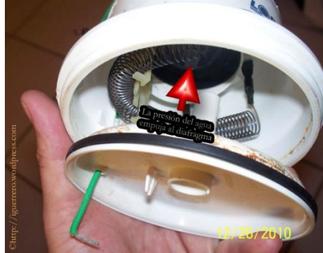
Figura 31. Ejemplo funcionamiento resistencia de paso.
