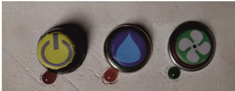
Figura 111. Elementos de control (pulsadores).
