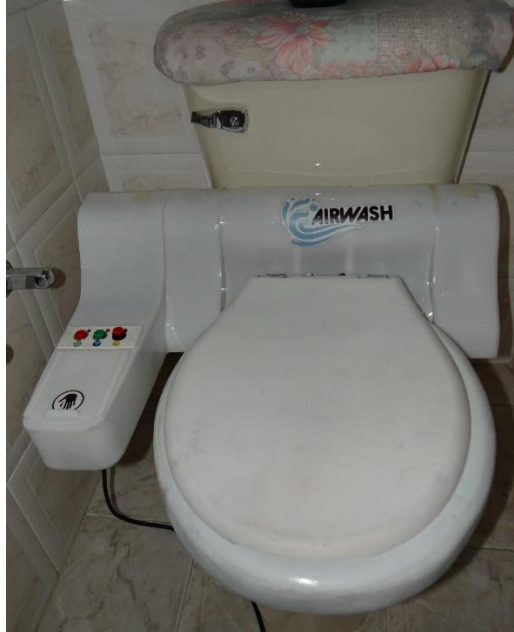
Figura 117. Fotografía modelo funcional final del dispositivo de higiene íntima sobre inodoro marca Corona convencional.
