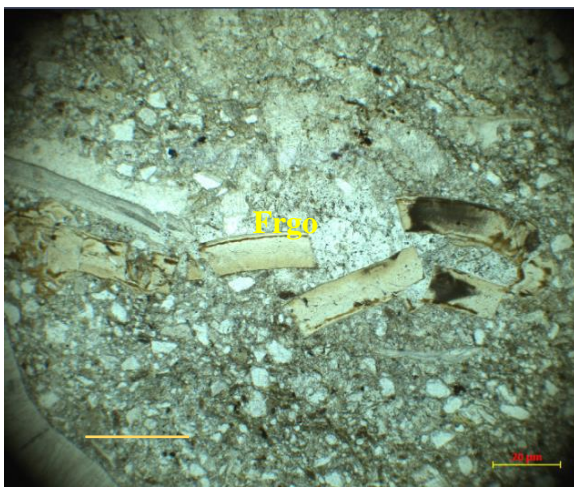
Figura 27. FroAc: Fragmento óseo de fosfato, Fosfato autigénico, Con Cemento espar y silíceo. 5x ppl
